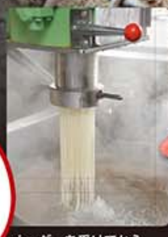
オーダーを受けてから専用の油圧式機械で製麺!
