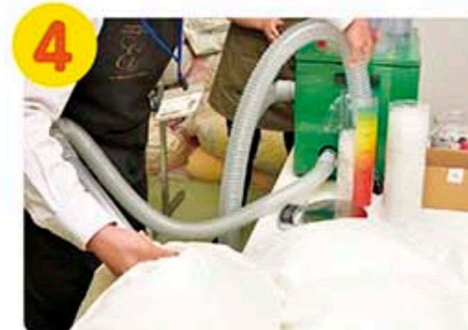
4 専用の機械を使用し、取り出した羽毛を戻します。羽毛を 足す場合も同じ機械を使用します。
