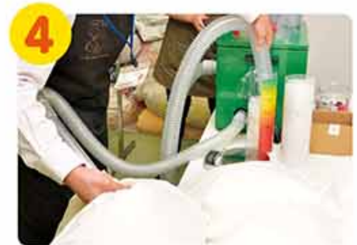
4 専用の機械を使用し、取り出した羽毛を戻します。羽 毛を足す場合も同じ機械を使用します。
